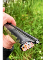
câble internet sectionné
