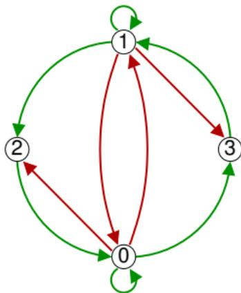
$$\begin{cases} f_0(x) = x_2 \vee (x_0 \wedge \neg x_1) \\ f_1(x) = x_3 \vee (\neg x_0 \wedge x_1) \\ f_2(x) = \neg x_0 \wedge x_1 \\ f_3(x) = x_0 \wedge \neg x_1 \end{cases}$$
